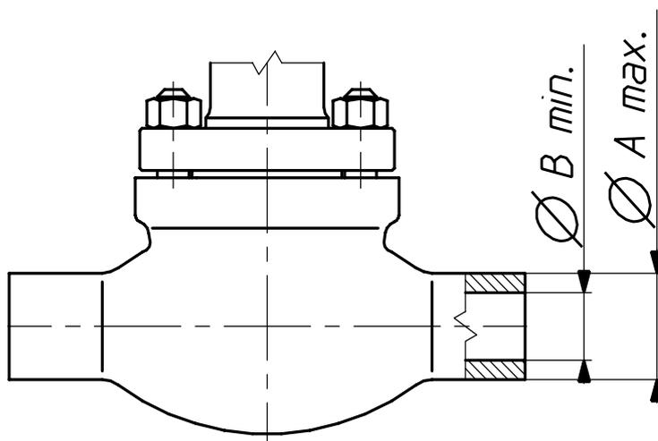
Рисунок 6. Размеры выводов для сварки, изготовленных из отливки.
