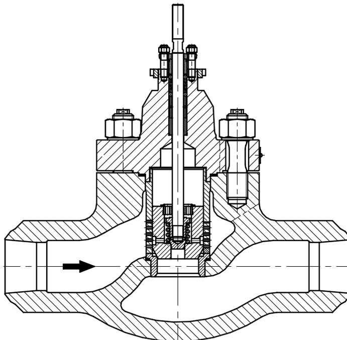
Рисунок 1в. Клапан Z1В - с плунжером, разгруженным при помощи пульса.
