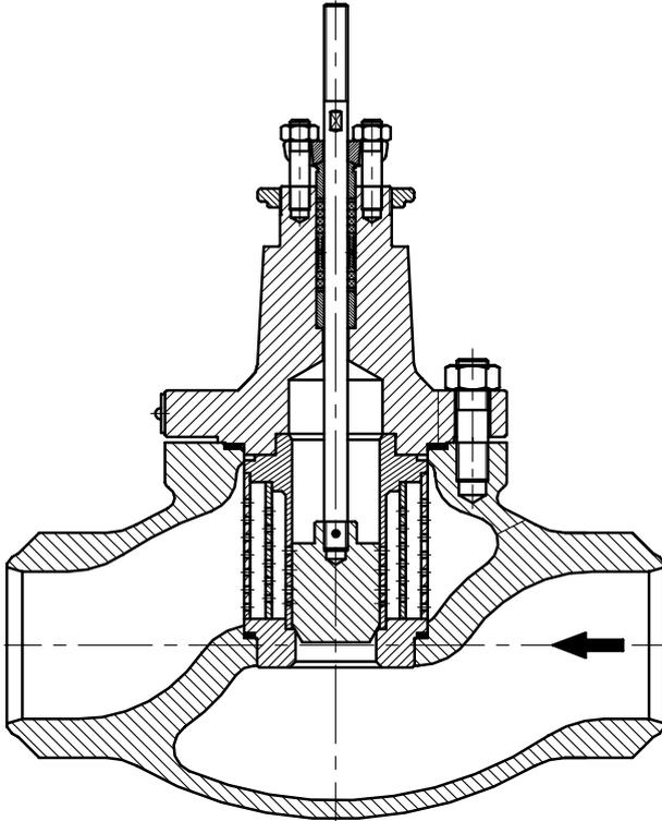
Рисунок 1а. Клапан Z1В - с неразгруженным плунжером.
