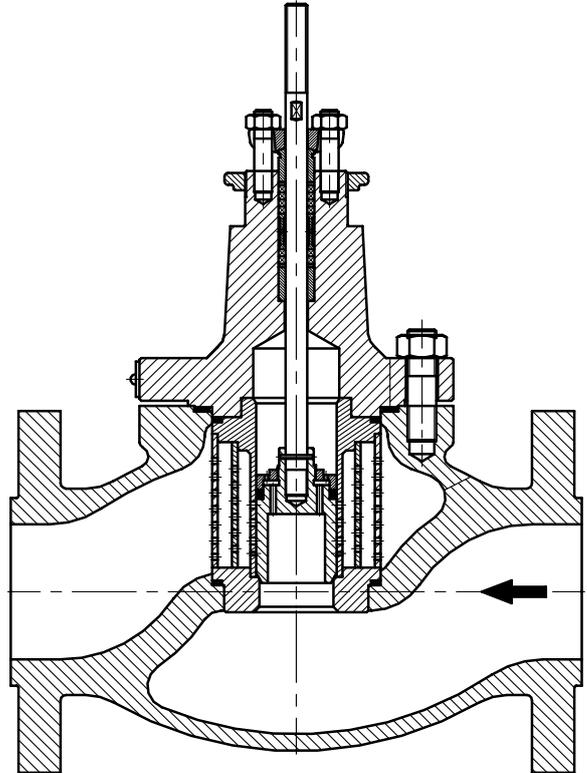
Рисунок 1б. Клапан Z1В - с разгруженным плунжером.
