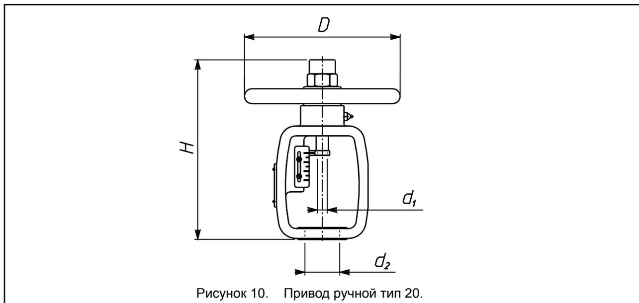
Рисунок 10. Привод ручной тип 20.
