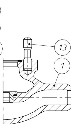
Корпус с окончаниями для стыковой сварки (тип BW)
